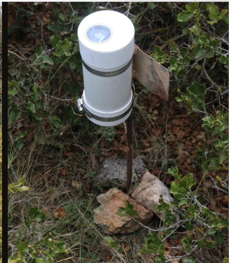
**Medición directa del brillo del cielo con el SQM-L e instalación del dispositivo de medición SQM-LE automático con su carcasa para toma de varias noches. Es prudente aislarlo del contacto físico con el suelo para evitar humedad y en lugar donde no sea visible para evitar su posible hurto.**
