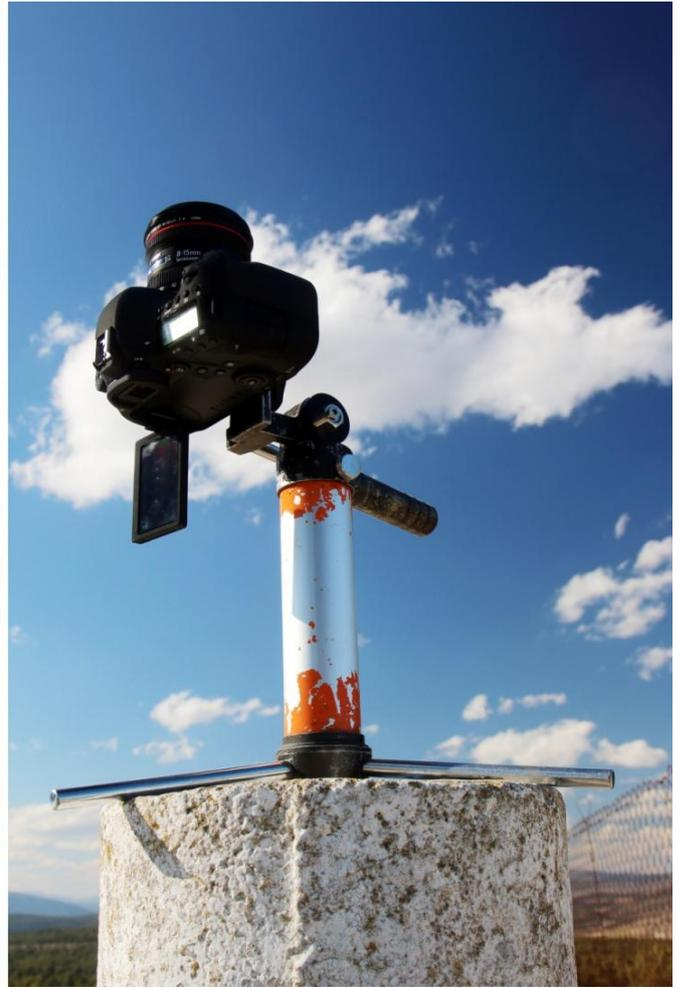
Vértice geodésico e instalación del equipo fotográfico en su cúspide. La posibilidad de uso de pantalla giratoria de la cámara nos permite trabajar con precisión y ver cómodamente los resultados.
