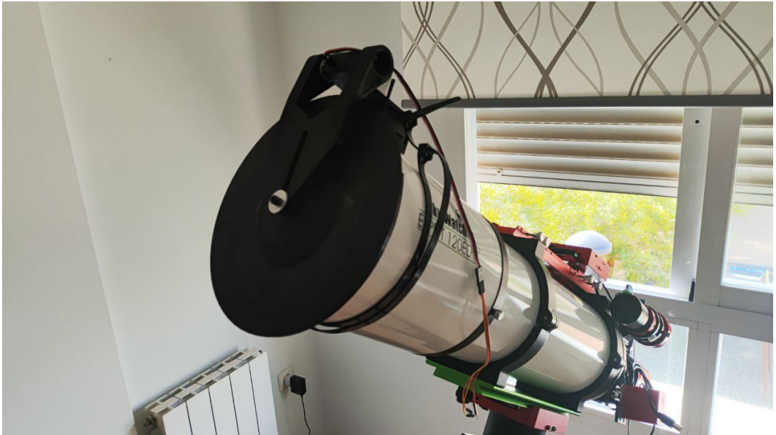
Figura 4. Panel automático de flats en telescopio Skywatcher Esprit 120 ED.
